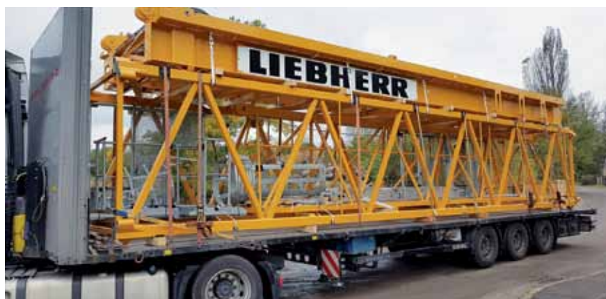
Elementy żurawia 202EC-B10 Litronic są transportowane w orientacji montażowej oraz w odpowiedniej kolejności dostarczone na miejsce montażu
